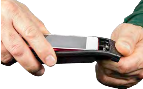
Schritt 5: DuraCase biegen, Anschlüsse ausrichten, Steckverbindung herstellen
