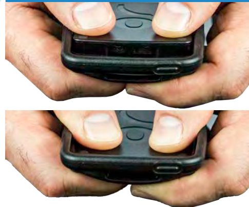
Schritt 6: Mobilgerät einrasten
