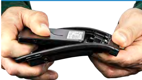
Schritt 2: DuraCase biegen, Anschlüsse ausrichten, Steckverbindung herstellen
